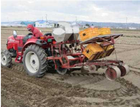
写真 専用に改造した移植機
