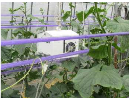
写真7 センサー、マイコン基盤を納める本体 (撮影：上川農業改良普及センター)
