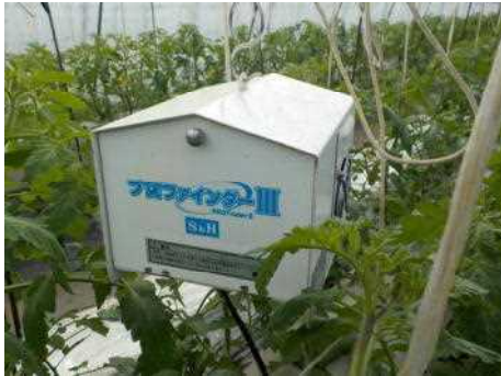
写真5 センサー、マイコン基盤を納める本体 (撮影：上川農業改良普及センター)
