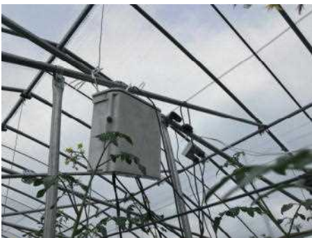
写真9 防水ボックス内に納めた本体 (撮影：ホクレン旭川支所)
