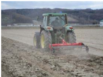
写真2 パラソイラによる心土破碎
