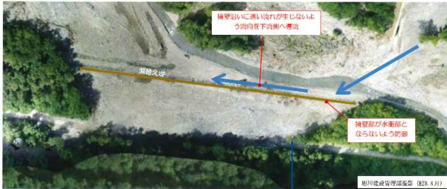
図3-1 瀬替堤設置の目的
