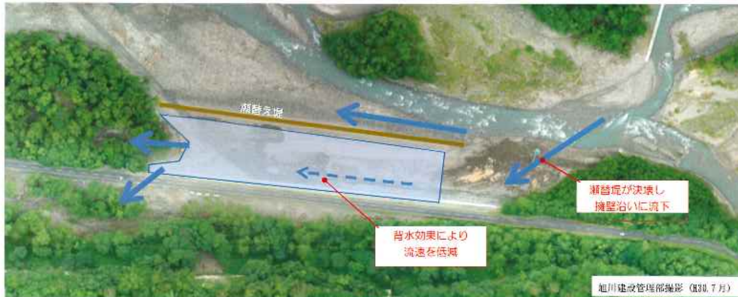
図3-2 被災時の瀬替堤の効果
