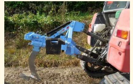
カットドレーンmini施工
