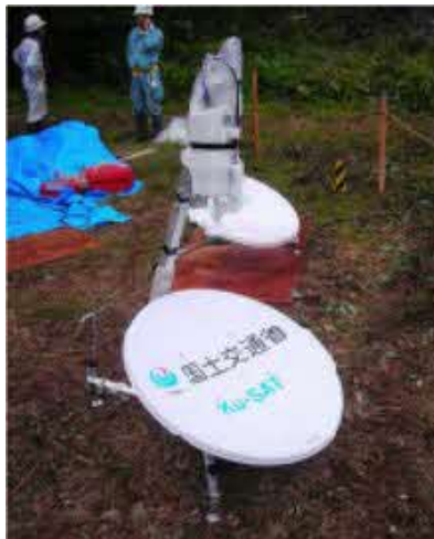
図 4.5 情報通信システム/機器の例（Ku-SAT（衛星小型画像転送装置））
